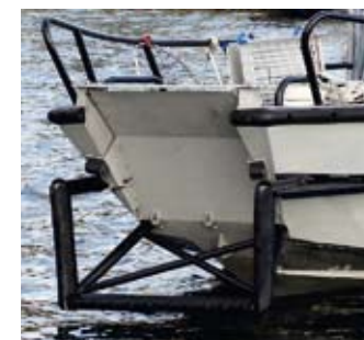
Den fasta och robusta ramen i fören är klädd med stötdämpande gummi. Rampen fälls ned via elektriskt ställdon (skruvkolv) som en landgång.
