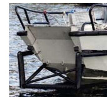
Den fasta och robusta ramen i fören är klädd med stötdämpande gummi. Rampen fälls ned via elektriskt ställdon (skruvkolv) som en landgång.
