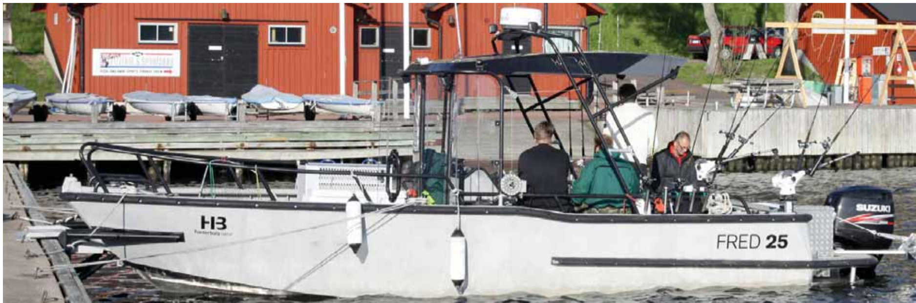
Fred 25 är en båt med speciellösningar som en fjärrstyrd ramp i fören. Båten är unik och välkomnar till ett båtsportfiske som inte tidigare varit möjligt för rörelsehindrade.
